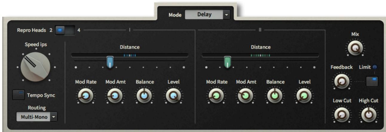
*Панель режима Delay с двумя воспроизводящими головками*
